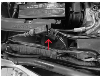
4. Installare la centralina precaricatore al posto dell'originale e collegare il suo connettore.
