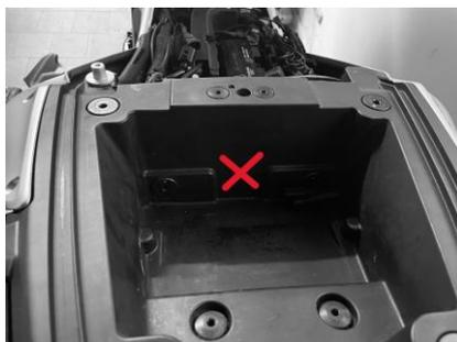
2. Fissare saldamente con viti autofilettanti le centraline, facendo passare i connettori nel foro fatto in precedenza.
